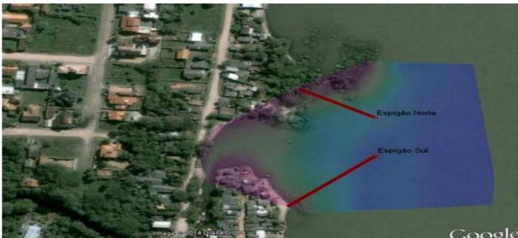
Figura 3. Vista em planta da posição e alinhamento dos 02 espigões na embocadura da Sanga das Charqueadas
